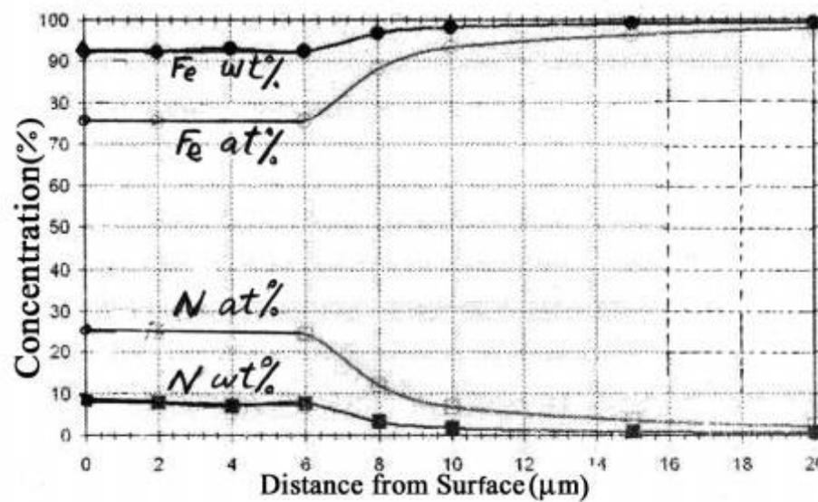
(۱) نفوذ غیر یکنواخت نیتروژن از سطح آهن تا عمق ۲۰ میکرون بطور پیوسته
