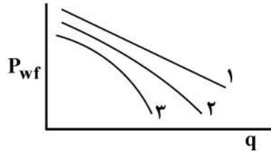
(۱) ۱- Solution gas drive-۲ Gas cap drive-۳ Water drive
