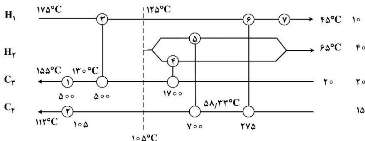
(۱) ۳ حلقه، حلقه [۵, ۷, ۲, ۴, ۶]، حلقه [۵, ۴, ۳, ۶, ۵] و حلقه [۲, ۴, ۵, ۶, ۱]
