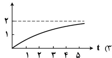
۲۶- پاسخ یک فشارسنج که تابع انتقال آن درجه ۲ می‌باشد، به ازای یک تغییر پله‌ای در فشار ورودی از ۱۰۰psi به ۱۵۰psi در شکل زیر رسم شده است. بهره (k) و فرکانس نوسان (ω) برای این فشارسنج به ترتیب چقدر است؟
