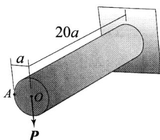
در نقطه A اعمال شود، جابه جایی نقطه محل اثر بار (با صرف نظر از اثر نیروی برشی) چند درصد افزایش می یابد؟
