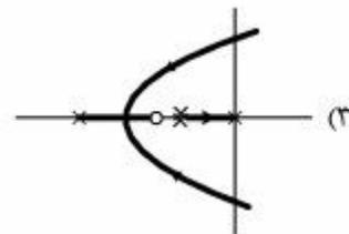
۴۲- برای تقریر قطب‌های مدار - بسته سیستم زیر در نقاط  $-1 \pm j\sqrt{3}$ ، انتخاب مناسب  $F_i$ ،  $i = 1, 2, 3$ ، کدام است؟
