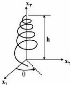
$$a_t = a\dot{\theta}^2 (\varphi + \theta^2)^{\frac{1}{2}} + a\ddot{\theta} \theta / (\varphi + \theta^2)^{\frac{1}{2}} \quad (۱)$$
