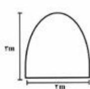
تونل اول:  $\gamma = 25 \text{ kN/m}^3$  RMR = ۸۴
