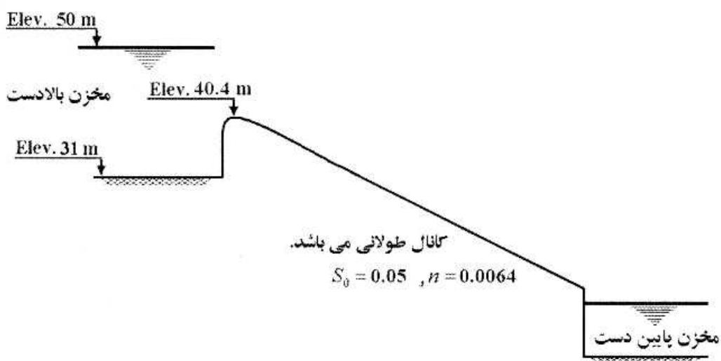
۱) شیب کanal اتصال بحرانی می‌باشد و در محل اتصال (ورودی) کanal عمق بحرانی شکل می‌گیرد.
